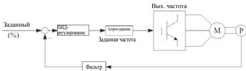
Рис. 6.19 Блок-схема ПИД-регулирования
